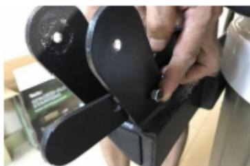
**Étape 12** : Dans cette dernière étape vous devez installer les bras hydrauliques dans les bras latéraux et les supports à l'aide de l'écrou et des bouchons. Attention au sens (voir ci-dessous)
