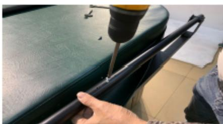
**Étape 11** : Relevez le lève couverture en position ouverture puis installez le verrou du côté dont vous souhaitez l'utiliser (à gauche ou à droite donc) à l'aide de la rondelle.
