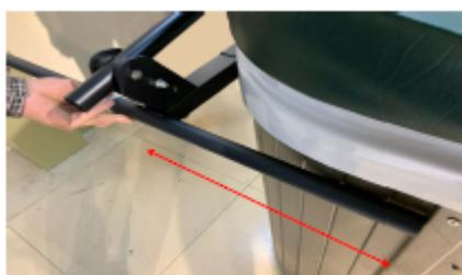
**Étape 8** : Après avoir confirmé que le lève couverture est correctement positionné utilisez les vis (12) pour percer et fixer définitivement les pièces 4 et 5 ensemble.
