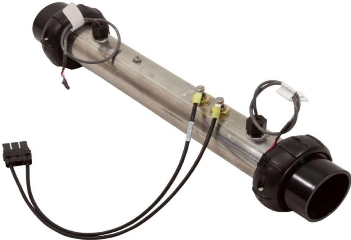
Les spas sont programmés pour atteindre une température maximale de 40°C ce qui correspond à environ 104°F. La sonde de surchauffe (Hi-Limit en anglais) est un élément de sécurité présent sur tous les spas, permettant de couper le chauffage si l'eau monte trop en température et dépasse cette limite afin que vous ne soyez pas amenés à vous brûler ou que la résistance ne casse. Les sondes sont généralement programmées pour se déclencher à environ 45 ou 48°C.
