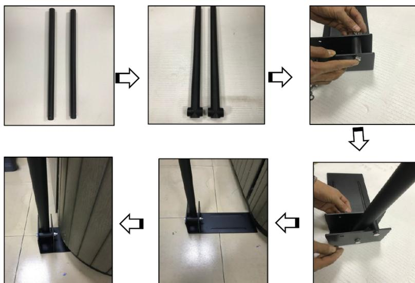
**Étape 2** : Associez les supports supérieur et inférieur du lève couverture (N°4) aux coupleurs (N°2) puis intégrez les dans les supports déjà montés en étape 1.
