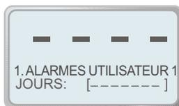
Appuyez sur le bouton de DEFILEMENT pour enregistrer le nouveau réglage et retourner au sous-menu alarmes utilisateur. Cela va complètement désactiver l'alarme d'utilisateur.
